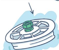
3 Insérez l'œillet du couvercle en PVC (A) dans le trou de 17 mm du couvercle.
