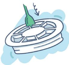
1 Bohren Sie mit einem Spiral- oder Schnellbohrer ein Loch Ø 17 mm in den Tank Deckel, um die Reinigung des Zellkerns so einfach wie möglich zu machen. Sie können auch einen zusätzlichen Tankdurchgang Ø 40 oder Ø 60 mm anbringen, in dem dann die obige Montage durchgeführt werden kann.
