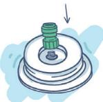
4. Bringen Sie 1 St. O-Ring (H) auf der Innenseite des Deckels um die PVC Deckeldurchführung (A) an und ziehen Sie den Einsatz (B) an der PVC Deckeldurchführung (A).
