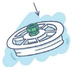
3. Stecken Sie die PVC Deckeldurchführung (A) durch das 17-mm-Loch im Deckel.
