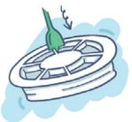
1. Bohren Sie mit einem Spiral- oder Schnellbohrer ein Loch Ø 17 mm ganz oben in den Tank Deckel, um die Wartung des Zellkerns so einfach wie möglich zu machen.
