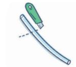
2. Kürzen Sie den Schlauch (C) ab, d.h. kürzen Sie den Schlauch auf die maximale Höhe im Inneren des Tanks, d.h. von der Unterseite des Tanks bis zur Unterseite des Deckels, **minus 10 cm**.
