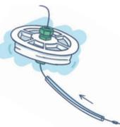
5. Stecken Sie nun zuerst den grünen Anschlussstecker (I) auf den Anschlusskabel (G). Siehe „Anschluss der Stromkabel an den grünen Stecker“. Führen Sie nun das Anschlusskabel (G) mit dem Rundstecker zuerst durch die PVC Deckeldurchführung (A), durch den Einsatz (B) und durch den konfektionierten Schlauch (C)
