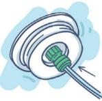
6. Drücken Sie dann den Schlauch (C) fest in den Einsatz (B) an der Unterseite der Deckel.
