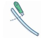
2. Coupez le tuyau (C) à longueur, c'est-à-dire raccourcissez le tuyau à la hauteur maximale à l'intérieur du réservoir, du bas du réservoir au bas du couvercle, **moins 8 cm.**
