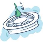
1. Percez un trou de Ø 17 mm dans le couvercle au top du réservoir avec un foret ou une meche à bois pour permettre l'entretien cellulaire simplement en levant le bouchon.
