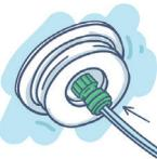
6. Poussez ensuite fermement le tuyau (C) (+/- 1,5 cm) dans l'insert (B) situé sous le couvercle.
