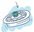
3. Insérez l'œillet du couvercle en PVC (A) d'en haut dans le trou de 17 mm du couvercle.
