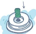
4. Faites passer la bague d'étanchéité plate (H) à l'intérieur du couvercle autour de l'œillet du couvercle en PVC (A) et serrez l'insert (B) sur l'œillet du couvercle en PVC (A).
