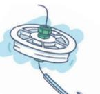
5. Montez d'abord la fiche de connexion verte (I) sur le câble de connexion (G). Voir "Connexion des câbles d'alimentation à la prise verte". Faites maintenant passer le câble de raccordement (G) avec la fiche ronde d'abord à travers le passage du couvercle en PVC (A), à travers l'insert (B) et à travers le tuyau sur mesure (C).
