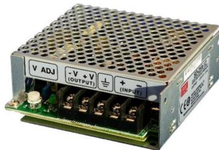
Placez le convertisseur CC entre le point de connexion d'alimentation continue 12V et le fusible, directement après le point de connexion, voir le schéma ci-dessous.
